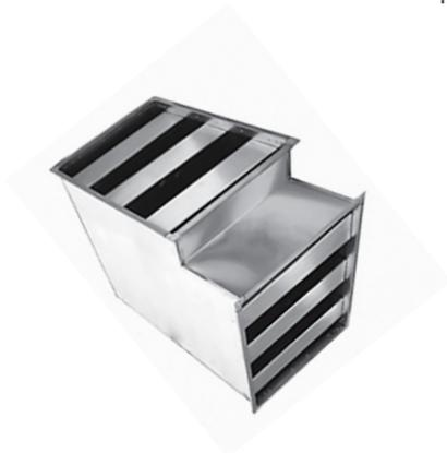
Шумоглушающие отводы (или коленчатые шумоглушители) серии ШУМ-ПЛ-8, сконструированные на основе стандартных пластинчатых шумоглушителей, используются при нехватке свободного пространства для установки шумоглушителей стандартного типа (ШУМ-ПЛ) и имеют форму обычного вентиляционного отвода для прямоугольных каналов с изгибом корпуса под углом 90°.
