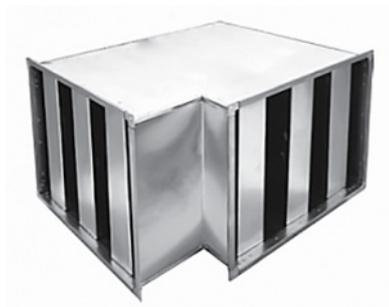
Шумоглушащие отводы (или коленчатые шумоглушители) горизонтального типа сконструированы на основе пластинчатых шумоглушителей (ШУМ-ПЛ) и используются при нехватке свободного пространства для установки шумоглушителей стандартного типа. ШУМ-ПЛ-9 имеют форму обычного вентиляционного отвода для прямоугольных каналов с изгибом корпуса под углом 90°.
