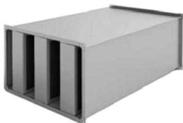
Пластинчатые шумоглушители для прямоугольных каналов серии ШУМ-ПЛ-7 устанавливаются в вентиляционные сети, отличающиеся большой производительностью. Конструктивно шумоглушители данного типа представляют собой корпус из оцинкованного металла толщиной до 1 мм, сечение которого соответствует размерам и форме воздуховода.
