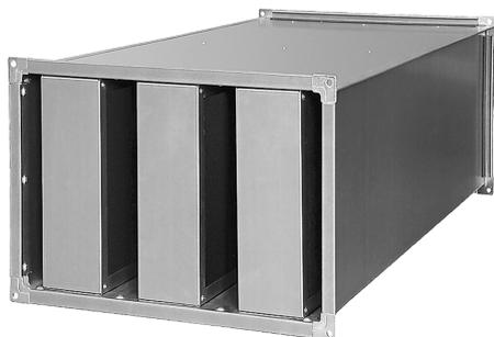
Шумоглушители пластинчатые каналные применяются в системах вентиляции и кондиционирования воздуха и предназначены для снижения аэродинамического шума и вибрации, создаваемых вентиляторами, кондиционерами, отопительными агрегатами, воздухоподающими устройствами, а также шума, возникающего в элементах вентиляционной сети. Помимо этого шумоглушитель снижает вибрацию, что повышает срок службы вентиляционной системы в целом.
