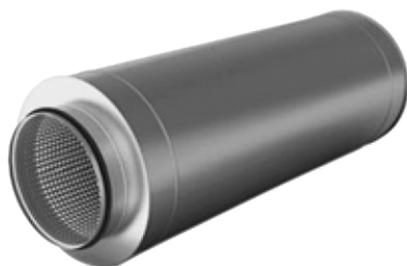
Трубчатые шумоглушители ШУМ-ТР-2 технически представляют собой две трубы разного диаметра, вставленные друг в друга, причем внутренняя труба выполнена из перфорированного материала, а ее диаметр равен диаметру воздуховода (до 800 мм). Образовавшееся пространство остается в виде воздушной прослойки.
