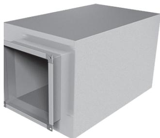
Трубчатые шумоглушители для прямоугольных каналов ШУМ-ПР-6 имеют форму короба прямоугольного сечения и состоят из каркасной части (изготавливается из оцинкованной стали), диафрагмы и металлического кожуха. Внутри корпуса устанавливаются звукопоглощающие минеральные пластины, толщина которых составляет 100 мм.
