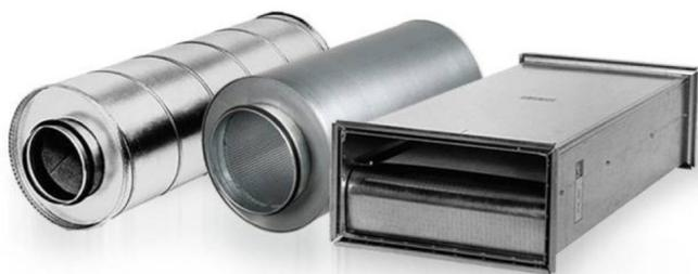
Поставляемые компанией ИНЕСИС шумоглушители можно разделить на два основных типа: трубчатые и пластинчатые, которые выпускаются как прямоугольного, так и круглого сечения. Пластинчатые шумоглушители нашли наибольшее применение на крупных (промышленных) объектах, тогда как трубчатые наиболее часто используются в небольших зданиях, в основном, жилого назначения, где уровень шума не является столь сильным. Корпус шумоглушителя может изготавливаться как из оцинкованной, так и из нержавеющей стали.
